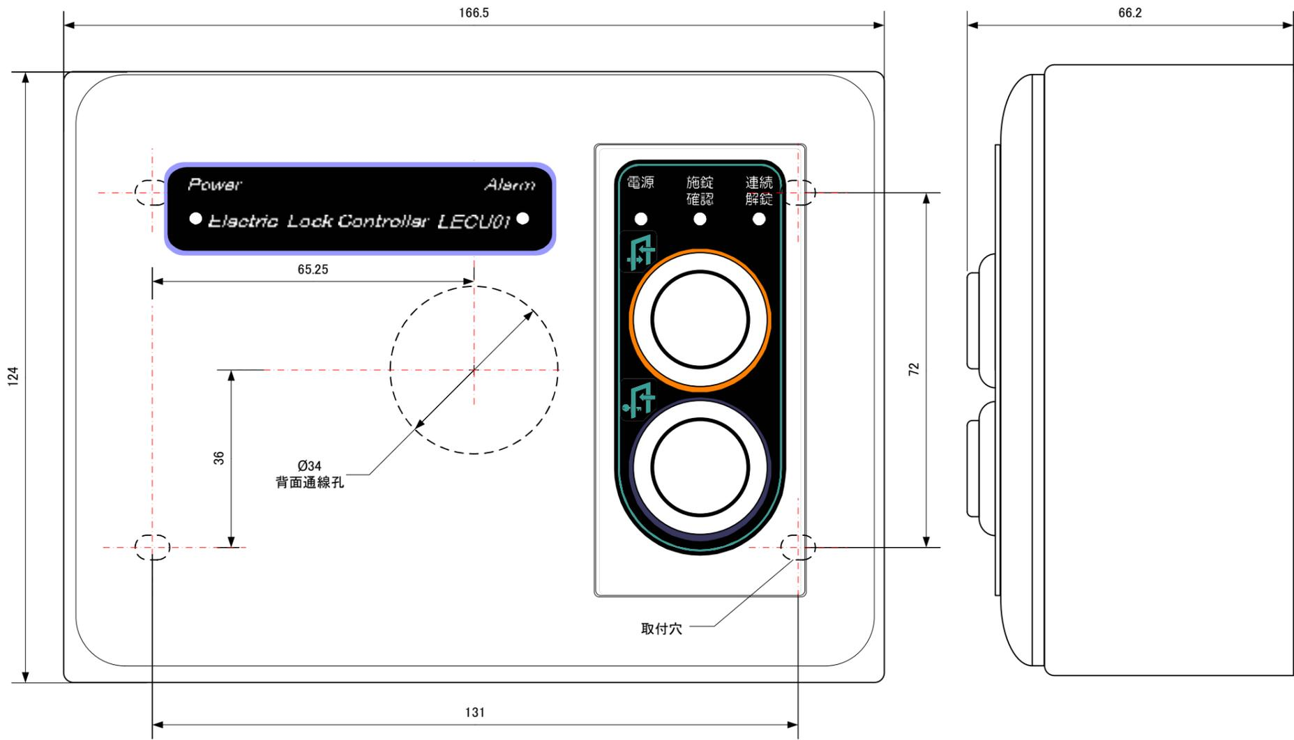
多機能型・電気錠制御盤(操作ボタン付) LECU01B 外形寸法図
