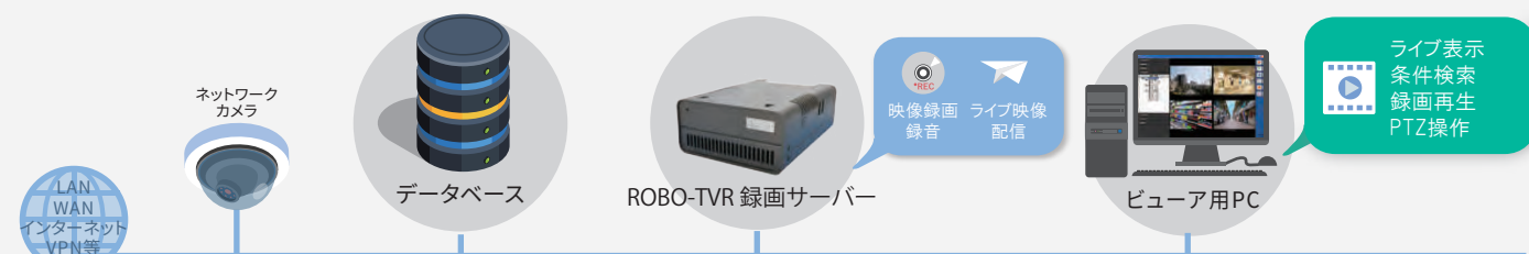
データベース連動映像システム基本構成イメージ図
